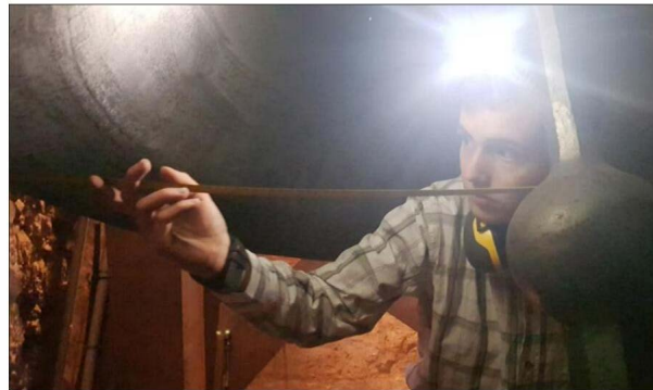
Le diamètre de chaque cloche est mesuré, et son usure analysée.
